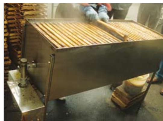
Im Herbst werden die Altwaben im Dampfwachsschmelzer eingeschmolzen, ohne Bienenflug ist dies im Freien möglich.
