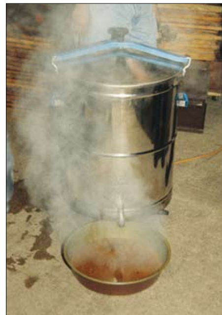
Im Herbst werden die Altwaben im Dampfwachsschmelzer eingeschmolzen, ohne Bienenflug ist dies im Freien möglich.
